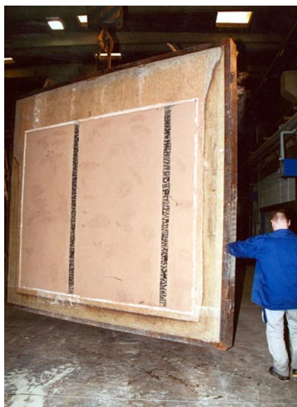
Figur 3. Lerpudset halmvæg testet vedrørende brandmodstandsevne på DBI. Tv. Halmvæg før prøvning. Th. Halmvæg efter prøvning. De bemærkes specielt at der ikke sket indbrænding i halmen mellem træstolperne og pudsen.
