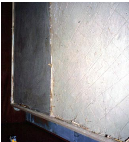
Figur 2. Varm-kold kasse på By og Byg. Her testes fugtophobningen i halmvægge med 2 forskellige pudstyper (ler- og kalkpuds).
